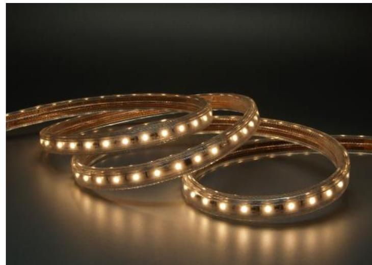
Le ruban LED CHV 230V est disponible en longueur de 10cm à 50 mètres en 1 morceau, il est sécable tous les 10cm et on peut raccorder bout à bout autant de ruban jusqu'à une longueur maximum de 50 mètres.
