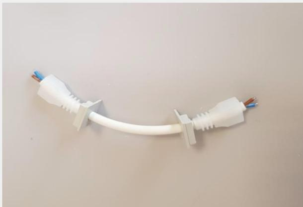
Préparer le cordon pour CHV en dénudant la gaine extérieure de 10mm de chaque côté (la partie métallique des fils doit être dénudée de 2mm).
