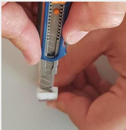
Délicatement retirer un peu de silicone à l'intérieur du ruban au-dessus des pads de soudure.
