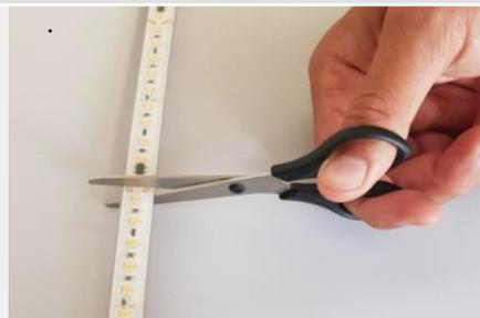
Mesurer la longueur souhaitée (nombre entier de sections de 100mm) et couper le ruban le long des pads de soudure.
