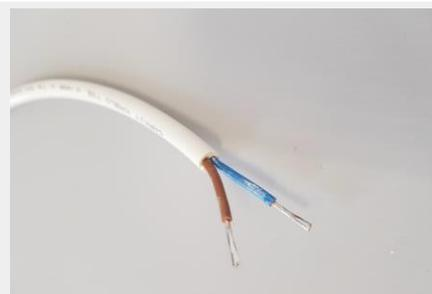
Dénuder la gaine extérieure du côté de la prise secteur de 30mm (la partie des fils en cuivre doit être dénudée de 10mm). Mettre de la soudure sur la partie dénudée des fils.
