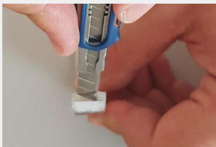
Délicatement retirer un peu de silicone à l'intérieur du ruban au-dessus des pads de soudure.
