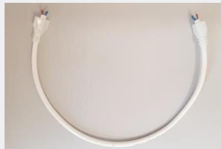
Préparer le cordon pour CHV en dénudant la gaine extérieure de 10mm de chaque côté (la partie des fils en cuivre doit être dénudée de 2mm). Mettre de la soudure sur la partie dénudée des fils.
