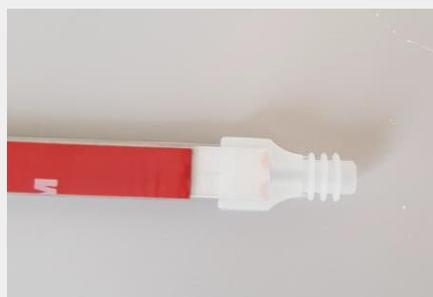
Procéder à la préparation de l'extrémité du ruban pour soudure: couper l'adhésif à 5 mm du bord de l'embout, retirer l'embout et la partie du film de protection de l'adhésif de l'extrémité.
