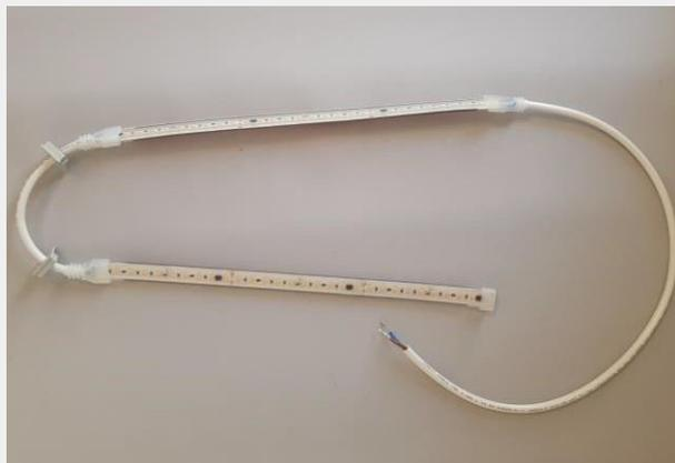
Souder le câble avec plaquettes de terminaison sur les rubans à chainer.
